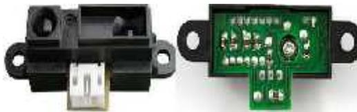
**Gambar 2.4 Bagian Depan dan Belakang Sensor SHARP GP2Y0A21**
