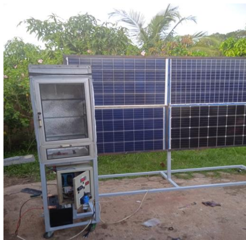
Gambar L3. 9 Penyelesaian Alat Oven Panel Surya
