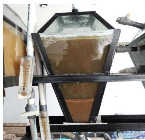
Pengamatan Volume *Slurry* pada Laju Alir 4 L/min pada Alat *Design II*
