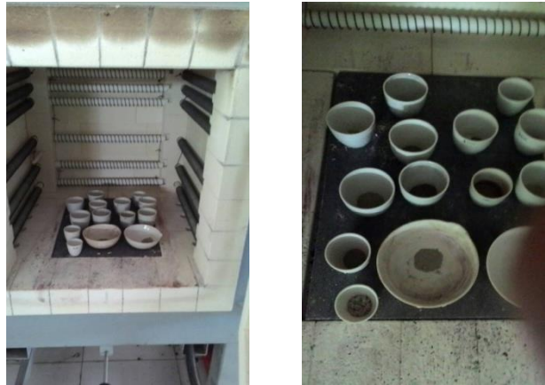
Gambar 21. Proses Penentuan Kadar Abu
