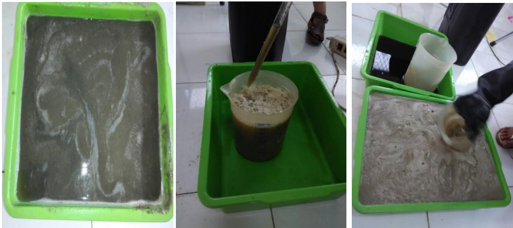
Gambar 24. Proses Pengolahan Limbah POME dengan cara Koagulasi menggunakan Koagulan PAC
