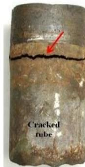
Gambar 2.6 Korosi retak pada pipa
