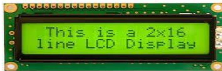
**Gambar 2.11. LCD tipe 2 x 16**
