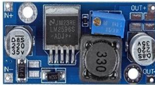
Gambar 2.7. Modul Konverter DC DC Penurun Tegangan (Sumber : LM 2596 Datasheet , 2013)
