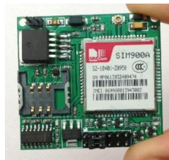
Gambar 2.28 SIM900A GSM GPRS Mini Modul (Famosa Studio : 2013)
