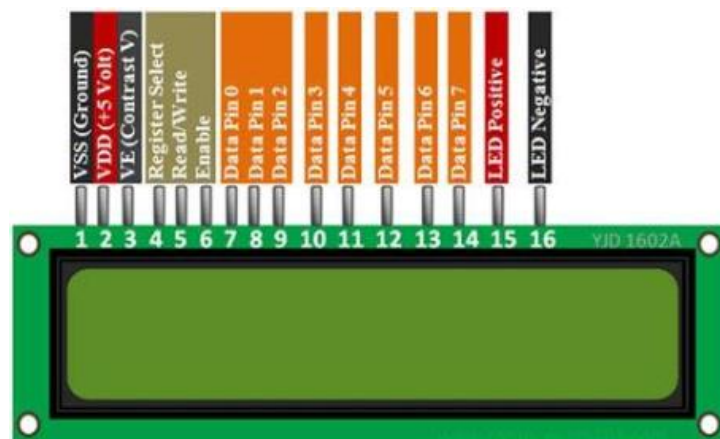
Gambar 2. 10 Konfigurasi Pin LCD I2C 16 x 2 [14]
