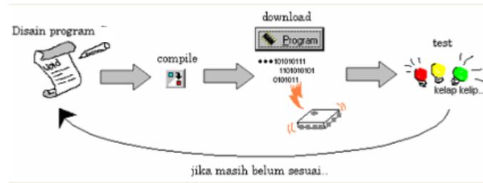
**Gambar 2.6 Proses Pemrograman Mikrokontroler**
