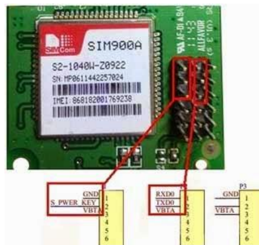
Gambar 2.5 Konfigurasi Pin SIM900A GSM GPRS Mini Modul (sumber: Data sheet SIM900A GSM/GPRS module)
