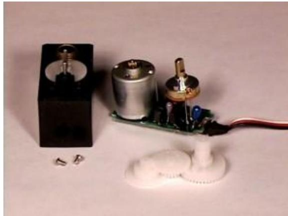
Gambar 2.8. Bagian Motor Servo
