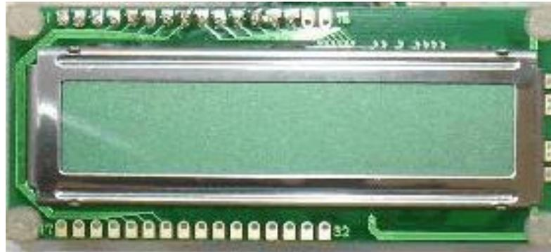
**Gambar 2.22.** Bentuk fisik LCD (*Liquid Crystal Display*)
