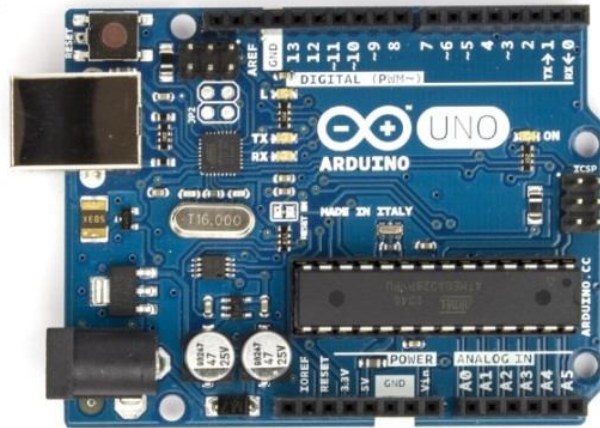
Gambar 2.13 Arduino UNO Tampak Depan Dinata, Yuwoono Marta, 2015: 3
