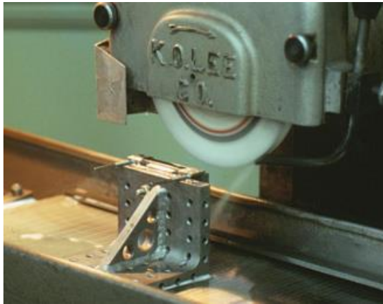
Gambar 2.55 Pengikatan benda kerja dengan balok penyiku (Teknik Permesinan Gerinda, 2021)
