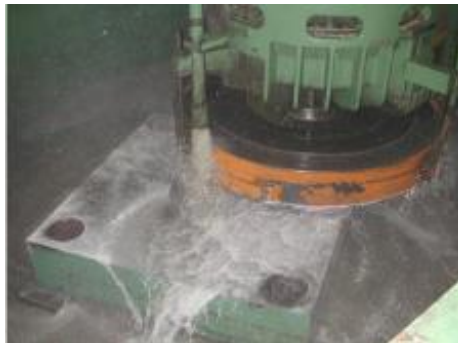
Gambar 2.6 Prinsip kerja mesin gerinda permukaan spindel vertikal dengan gerak meja bolak-balik (Teknik Permesinan Gerinda, 2021)
