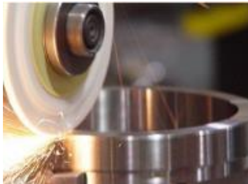
Gambar 2.4 Prinsip kerja mesin gerinda permukaan spindel horizontal dengan gerak meja berputar (Teknik Permesinan Gerinda, 2021)
