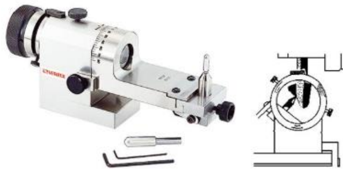
Gambar 2.33 Pembentuk radius pada sudut roda gerinda dengan kaca pembesar/ optic (Teknik Permesinan Gerinda, 2021)
