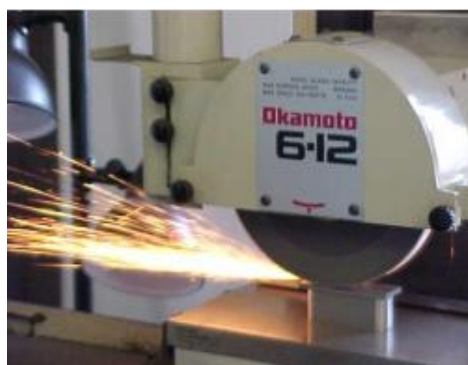
Gambar 2.1 Prinsip kerja mesin gerinda permukaan spindel horizontal dengan gerak meja bolak-balik (Teknik Permesinan Gerinda, 2021)
