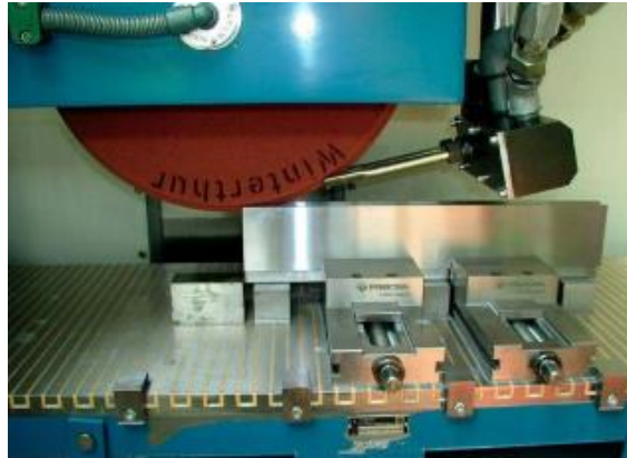
Gambar 2.49 Pengikatan benda kerja berukuran relatif panjang (Teknik Permesinan Gerinda, 2021)
