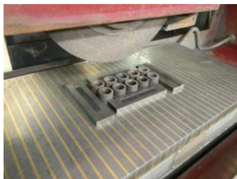
Gambar 2.52 Pengikatan benda kerja yang memiliki ukuran relatif kecil (Teknik Permesinan Gerinda, 2021)
