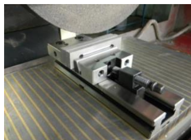
Gambar 2.48 Kondisi ragum presisi harus bersih (Teknik Permesinan Gerinda, 2021)
