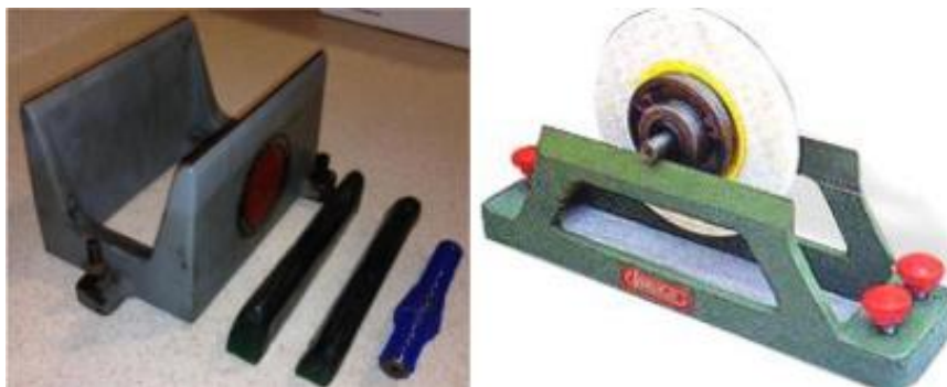
Gambar 2.43 Dudukan penyetimbang dengan batang pipih dan contoh penggunaannya (Teknik Permesinan Gerinda, 2021)
