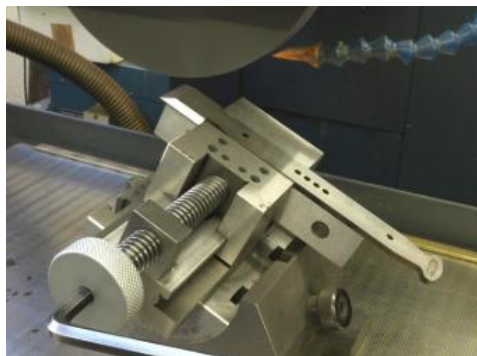
Gambar 2.56 Pengikatan benda kerja ragum sudut unuversal presisi (Teknik Permesinan Gerinda, 2021)
