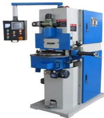
Gambar 2.9 Mesin gerinda permukaan posisi spindel vertikal dengan gerak meja berputar (kolom mesin satu buah) (Teknik Permesinan Gerinda, 2021)
