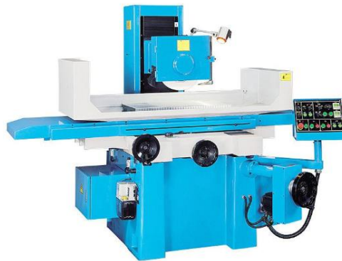
Gambar 2.2 Mesin gerinda permukaan spindel horizontal dengan gerak meja bolak-balik (Teknik Permesinan Gerinda, 2021)
