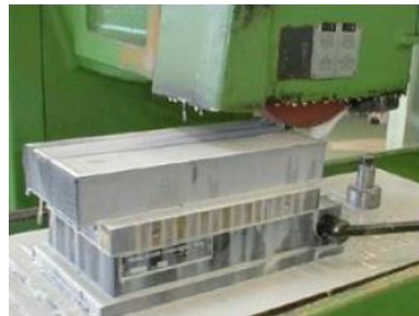
Gambar 2.57 Penggunaan media pendingin pada proses penggerindaan datar (Teknik Permesinan Gerinda, 2021)
