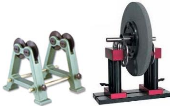
Gambar 2.45 contoh penggunaan dudukan penyetimbang dengan rol dan contoh penggunaannya (Teknik Permesinan Gerinda, 2021)
