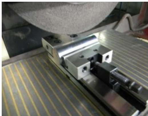
Gambar 2.50 Pengikatan benda kerja yang memiliki ukuran relatif pendek (Teknik Permesinan Gerinda, 2021)
