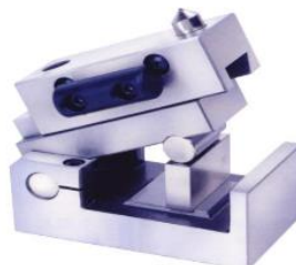
Gambar 2.30 Sinus pembentuk sudut roda gerinda (Teknik Permesinan Gerinda, 2021)
