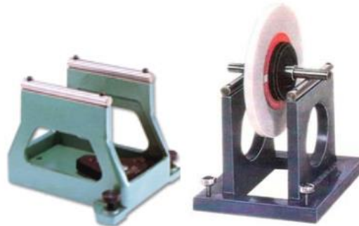
Gambar 2.44 Dudukan penyetimbang dengan batang lurus dan contoh penggunaannya (Teknik Permesinan Gerinda, 2021)
