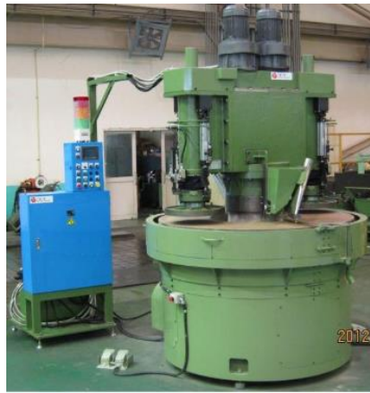
Gambar 2.11 Mesin gerinda permukaan posisi spindel vertikal dengan gerak meja berputar (spindel mesin dua buah) (Teknik Permesinan Gerinda, 2021)
