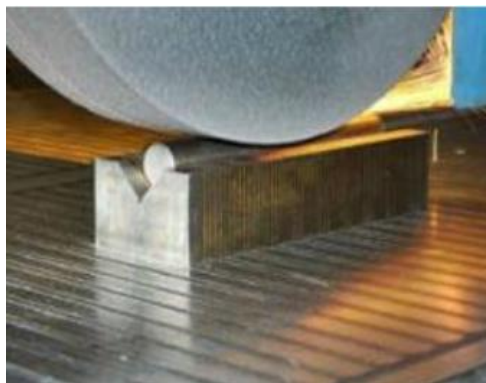
Gambar 2.54 Pengikatan benda kerja dengan balok penghantar magnet alur V (Teknik Permesinan Gerinda, 2021)
