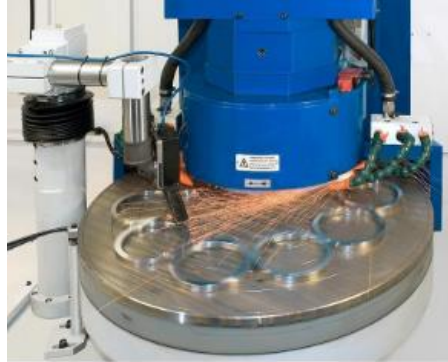
Gambar 2.8 Prinsip kerja mesin gerinda permukaan spindel vertikal dengan gerak meja berputar (Teknik Permesinan Gerinda, 2021)
