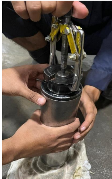
Lampiran 10 Foto Kegiatan pada Saat Pembongkaran Pengunci Poros Batu Gerinda
