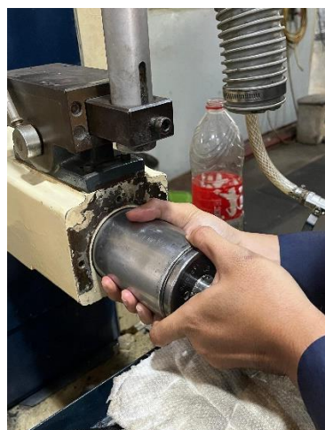
Lampiran 9 Foto Kegiatan pada Saat Pembongkaran/Pemasangan Poros Batu Gerinda
