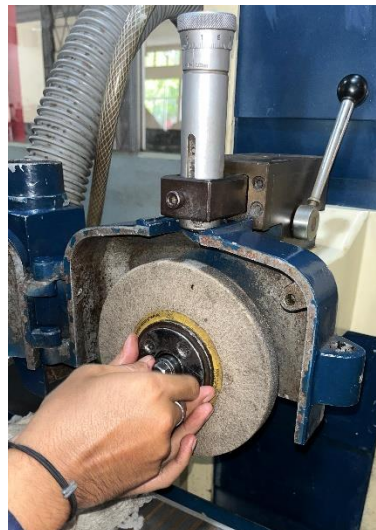
Lampiran 8 Foto Kegiatan pada Saat Pembongkaran/Pemasangan Batu Gerinda
