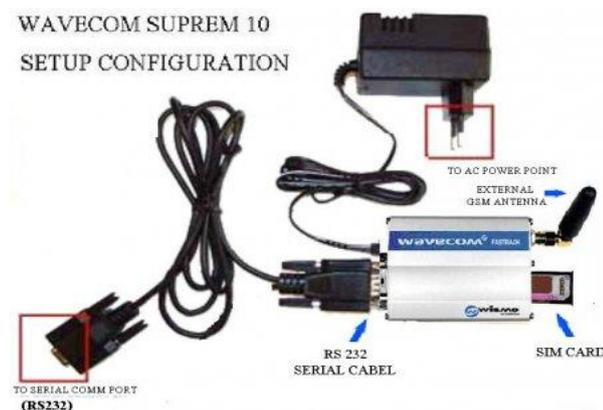
**Gambar 2.21 Modem Wavecom**
