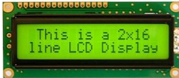
Gambar 2.6 Bentuk Fisik LCD (Liquid Crystal Display)
