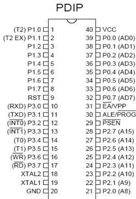
**Gambar 2.8 Konfigurasi pin I/O pada AT89S52**
