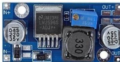
**Gambar 2.10.** Modul Konverter DC DC Penurun Tegangan
