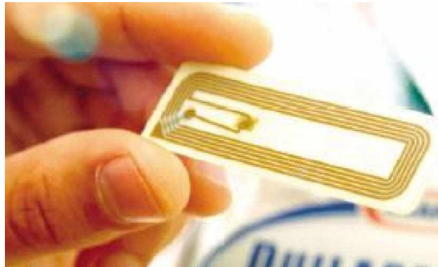
Gambar 2.5 RFID tag dengan silicon chip dan antena eksternal
