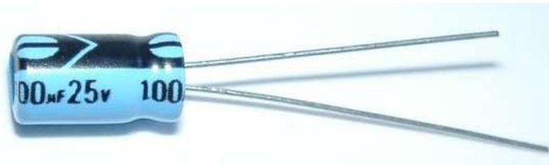
**Gambar 2.21** Kapasitor Elektrolit
