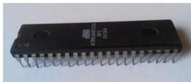
**Gambar 2.5** Mikrokontroller ATmega8535
