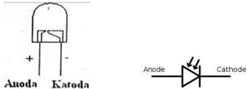
Gambar 2.2 Bentuk dan Simbol Photodioda
