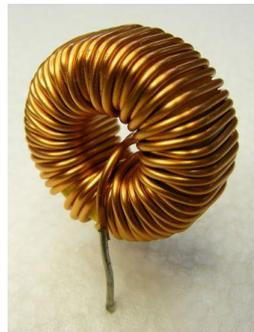
**Gambar 2.10 Bentuk Fisik Induktor**
