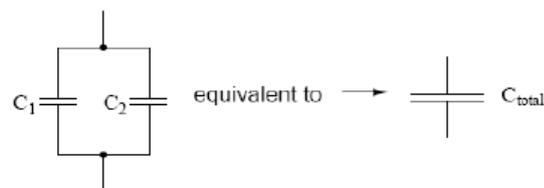
**Gambar 2.17 Rangkaian Paralel pada Kapasitor**
