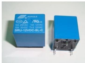
**Gambar 2.3.** Bentuk fisik *relay* SRU-12VDC-SL-C
