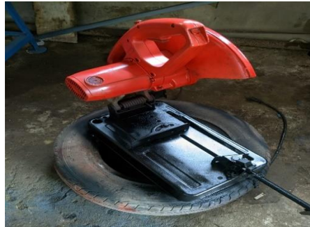
Gambar 2.1 Bentuk fisik mesin gerinda potong
