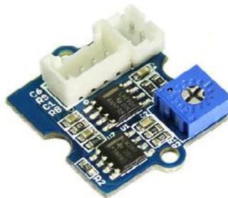
**Gambar 2.6 Sensor Piezo Vibration**
