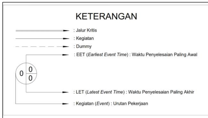
Gambar 2.24 Keterangan Critical Path Method pada Network Planning (Sumber : Ervianto, Wulfram I. 2007)
