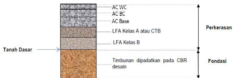
Gambar 2.27 Perkerasan lentur pada timbunan
