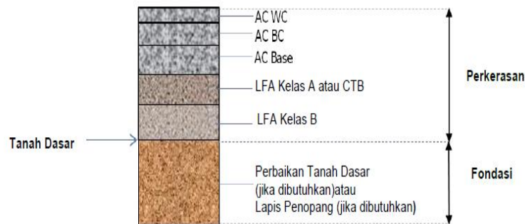
Gambar 2.26 Perkerasan lentur pada permukaan tanah asli
