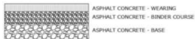
Gambar 2.6 Lapisan Aspal Beton AC-WC, AC-BC, dan AC-Base
