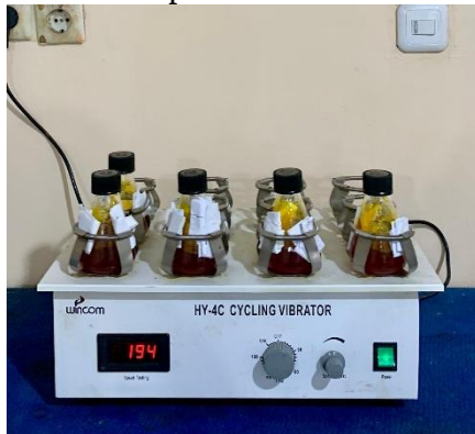
Gambar C.7. Melakukan proses running pembuatan Biodiesel dengan Stirred Tank Reactor dengan variasi enzim lipase dan waktu reaksi yang berbeda, masukan methanol secara bertahap
