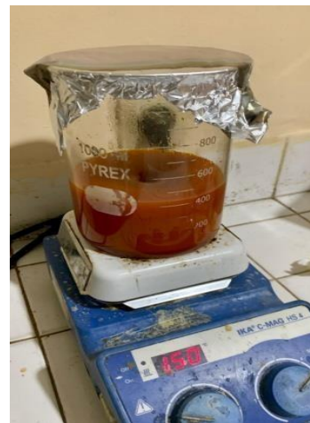
Gambar C.4. Setelah pencucian masukan kedalam gelas kimia lalu dipanaskan lagi sampai air dan methanol menguap
