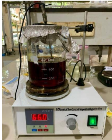
Gambar C.1. Menimbang Biodiesel Sebanyak 500 ml kemudian masukan kedalam gelas kimia dan dipanaskan sampai temperature 90°C lalu tambahkan larutan etanol 15% dan H 2 SO 4 1% sedikit demi sedikit dan diamkan sampai suhu ruang
