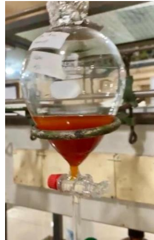
Gambar C.2. Setelah itu, masukan kedalam corong pisah lalu diamkan sampai membentuk 2 lapisan. Setelah didiamkan lakukan proses pencucian
