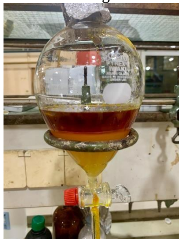
Gambar C.1. Menimbang Biodiesel Sebanyak 500 ml kemudian masukan kedalam gelas kimia dan dipanaskan sampai temperature 90°C lalu tambahkan larutan etanol 15% dan H 2 SO 4 1% sedikit demi sedikit dan diamkan sampai suhu ruang
