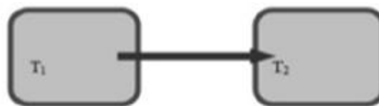
Gambar 1. Ilustrasi Perpindahan Panas dari Temperatur Tinggi ke Temperatur Rendah
