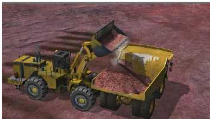
Gambar 2.5 *Wheel Loader* pada Posisi *L Loading*
