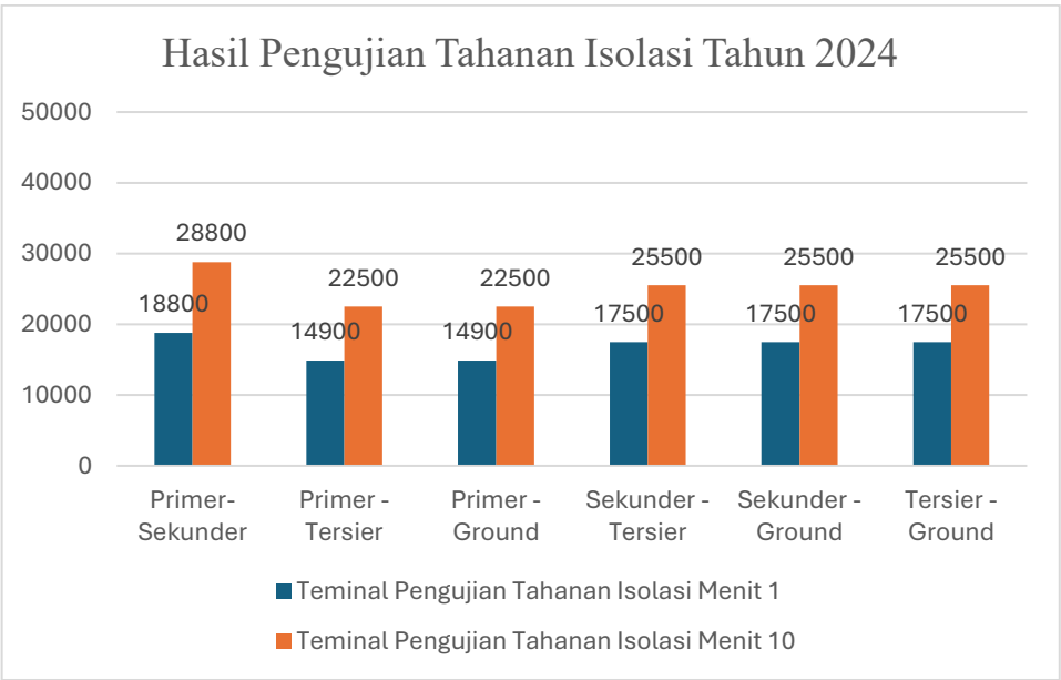
Gambar 4. 1 Grafik Hasil Pengujian Tahanan Isolasi Tahun 2024
