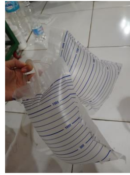
H 2 hasil reaksi hidrolisis aluminium ditampung dalam sample bag untuk pengukuran volume gas
