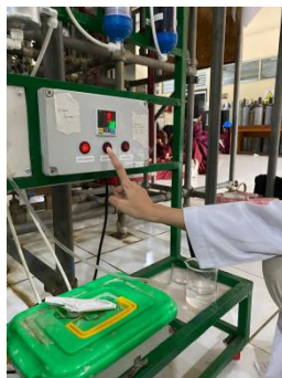
Memanaskan reaktor dengan temperatur 60^{\circ}C
