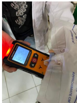
Pengukuran volume gas hidrogen (H 2 ) yang dihasilkan menggunakan alat Gas Analyzer
