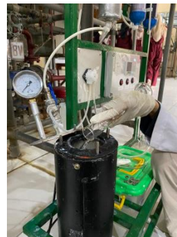
Menambahkan H_2O sebanyak 300ml dan NaCl yang telah dilarutkan
