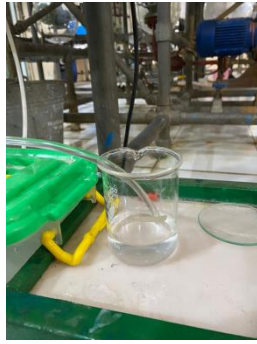
Mengalirkan katalis NaOH ke dalam reaktor untuk memulai reaksi hidrolisis aluminium
