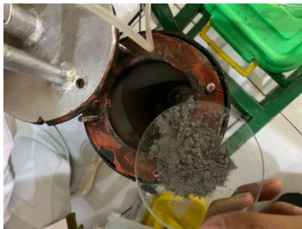
Memasukkan bahan baku ke dalam reaktor
