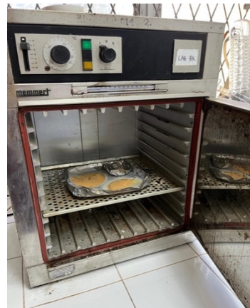
Endapan \text{ZnO/ NiFe}_2\text{O}_4 di oven pada suhu 100^\circ\text{C} selama 6 jam.
