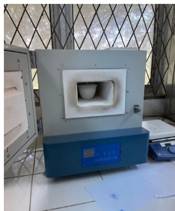
Kalsinasi ZnO pada suhu 500 °C selama 2 jam
