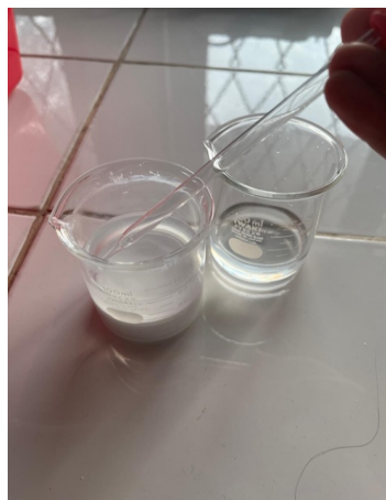
Endapan yang terbentuk kemudian dicuci menggunakan aquadest hingga pH netral.
