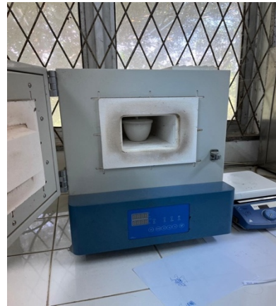
Kalsinasi pada suhu 500^\circ\text{C} selama 2 jam untuk memperoleh nanokomposit \text{ZnO}/\text{NiFe}_2\text{O}_4
