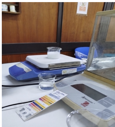
Melarutkan seng asetat dihidrat dan diaduk dengan kecepatan 300 rpm selama 1 jam pada suhu 25 °C
