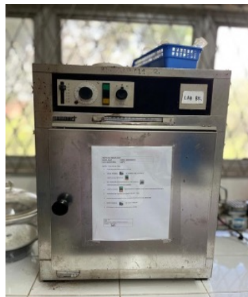
Endapan selanjutnya dikeringkan menggunakan oven pada suhu 120 °C selama 2 jam
