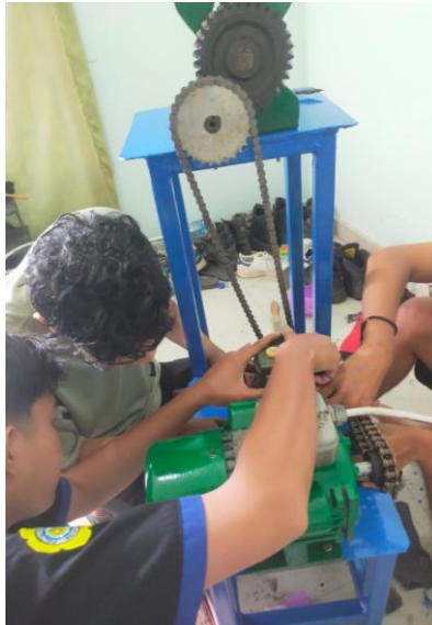
Gambar 4.7 Pemasangan Gearbox dan Motor Listrik
