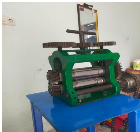
Gambar 4.6 Pemasangan Sistem Rolling Pada Rangka
