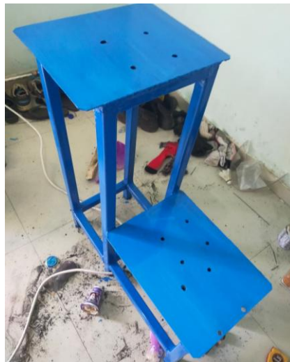
Gambar 4.5 Pemasangan Plat Rangka
