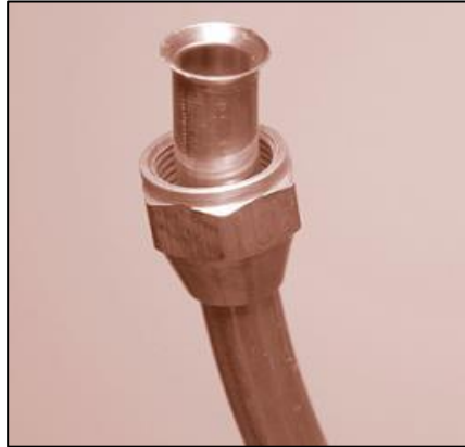
Gambar 2.8 Pipa Hasil Pengembangan ( Flare )
