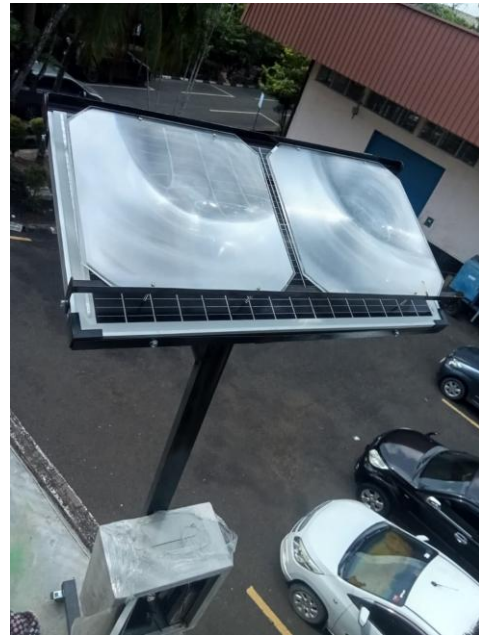
(d) Menggunakan Lensa Fresnel
