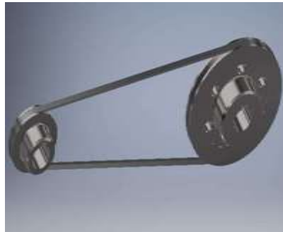
Gambar 3. 4 Sistem Transmisi Pulley dan V-Belt
