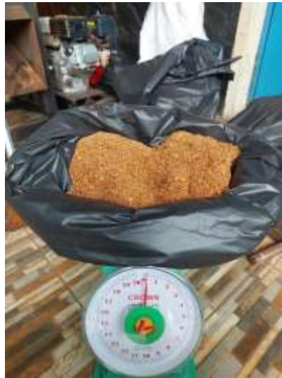
Gambar 4. 10 Hasil Cocopeat Uji 1 Menggunakan Mata Pisau Granulator blade dalam Kondisi Tidak Habis Sumber: Dokumentasi Penelitian (2026)
