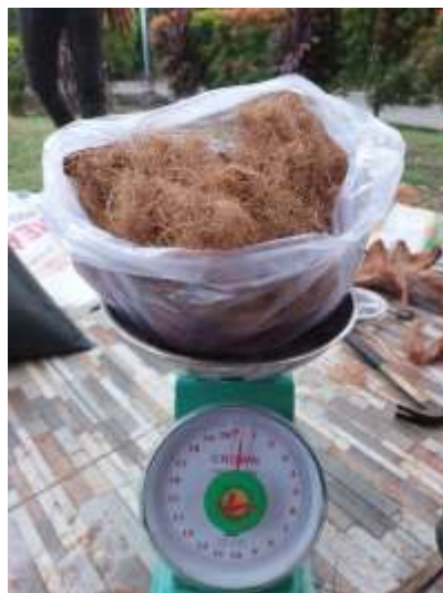
Gambar 4. 5 Hasil Cocofiber Uji 2 Menggunakan Mata Pisau Hammer blade dalam Kondisi Tidak Habis
