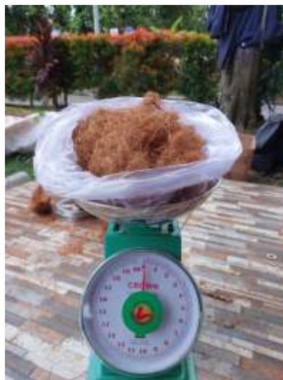
Gambar 4. 7 Hasil Cocofiber Uji 3 Menggunakan Mata Pisau Hammer blade dalam Kondisi Habis
