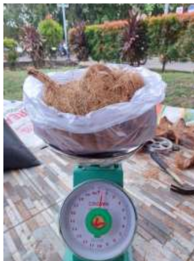
Gambar 4. 3 Hasil Cocofiber Uji 1 Menggunakan Mata Pisau Hammer blade dalam Kondisi Tidak Habis
