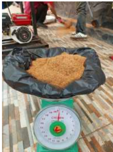
Gambar 4. 8 Hasil Cocopeat Uji 1 Menggunakan Mata Pisau Knife blade dalam Kondisi Habis
