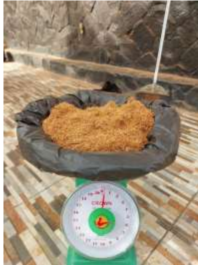
Gambar 4. 12 Hasil Cocopiet Uji 2 Menggunakan Mata Pisau Granulator blade dalam Kondisi Habis
