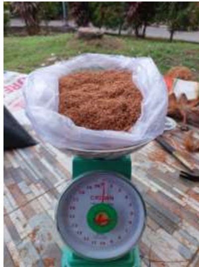
Gambar 4. 4 Hasil Cocopeat Uji 2 Menggunakan Mata Pisau Hammer blade dalam Kondisi Tidak Habis
