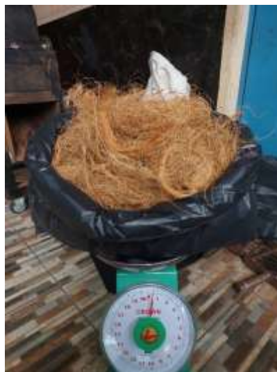
Gambar 4. 11 Hasil Cocofiber Uji 1 Menggunakan Mata Pisau Granulator blade dalam Kondisi Tidak Habis Sumber: Dokumentasi Penelitian (2026)
