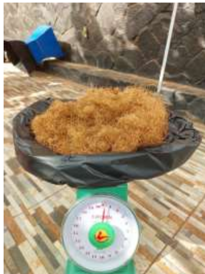
Gambar 4. 13 Hasil Cocofiber Uji 2 Menggunakan Mata Pisau Granulator blade dalam Kondisi Habis
