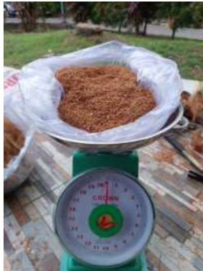
Gambar 4. 2 Hasil Cocopeat Uji 1 Menggunakan Mata Pisau Hammer blade dalam Kondisi Tidak Habis
