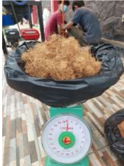
Gambar 4. 9 Hasil Cocofiber Uji 1 Menggunakan Mata Pisau Knife blade dalam Kondisi Habis
