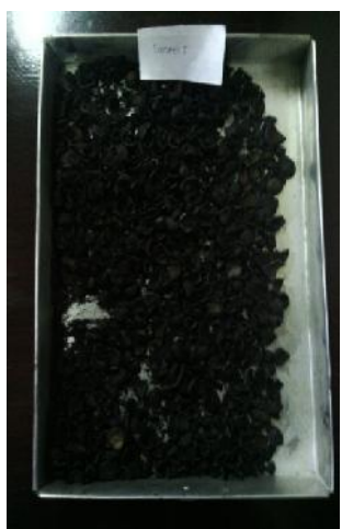
Gambar 20. Cangkang Kemiri Sampel 5 Setelah Pirolisa
