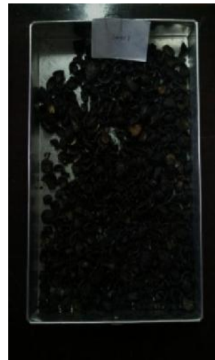
Gambar 17. Cangkang Kemiri Sampel 2 Setelah Pirolisa
