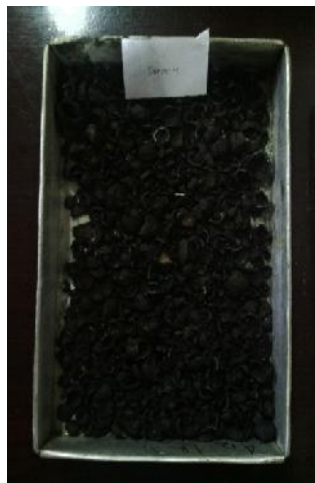
Gambar 19. Cangkang Kemiri Sampel 4 Setelah Pirolisa
