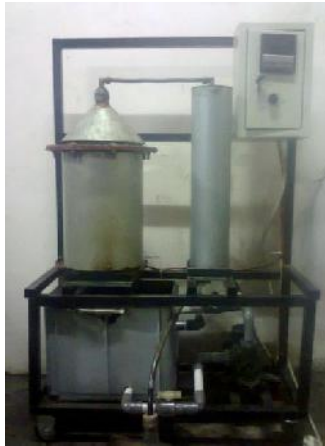
Gambar 9. Seperangkat Alat Pirolisa Asap Cair
