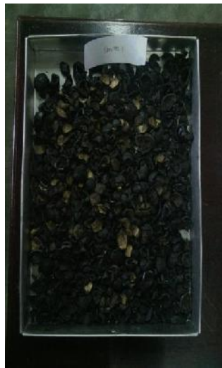
Gambar 16. Cangkang Kemiri Sampel 1 Setelah Pirolisa
