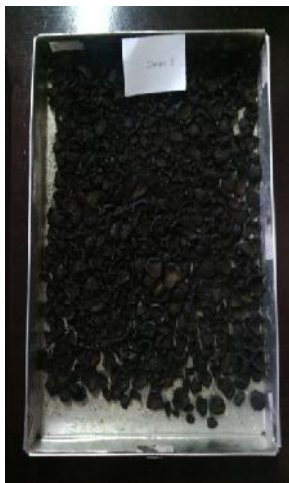
Gambar 18. Cangkang Kemiri Sampel 3 Setelah Pirolisa
