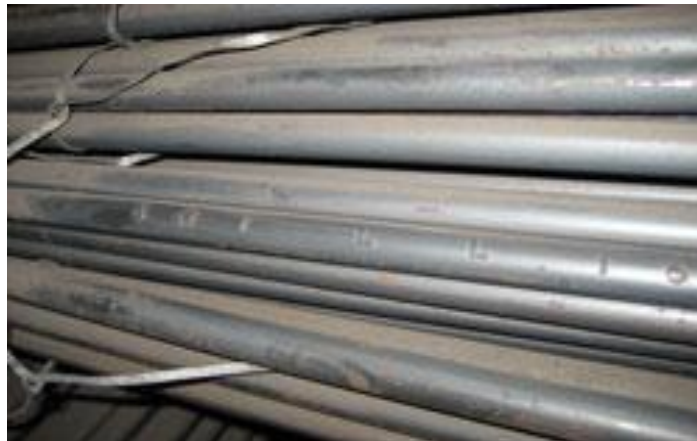
Gambar 2.1 Baja tulangan beton polos
