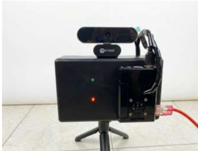
Gambar 4. 10 LED Merah Menyala sebagai Indikator Belum Siap Panen
