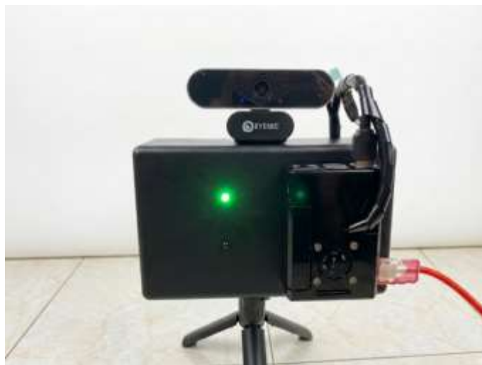
Gambar 4. 9 LED Hijau Menyala sebagai Indikator Siap Panen
