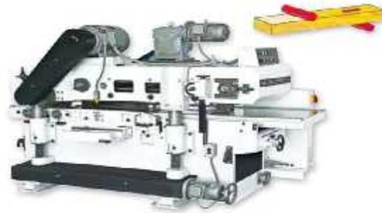
Gambar 2.4 Mesin Serut Otomatis
