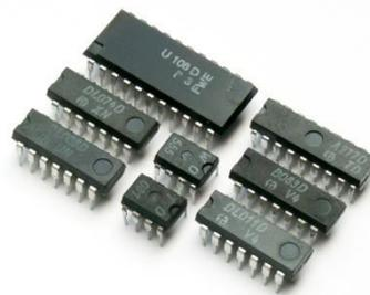
Gambar 2.14. Rangkaian Terpadu (IC)
