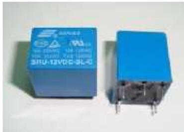
**Gambar 2.10.** Bentuk fisik *relay* SRU-12VDC-SL-C
