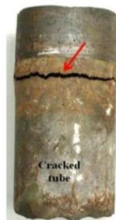
Gambar 6 Korosi retak pada pipa
