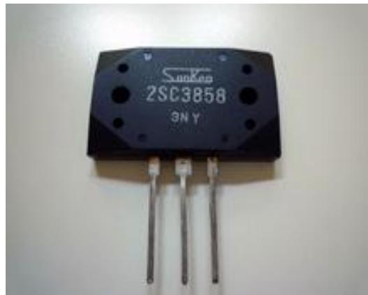
**Gambar 2.10** Bentuk Fisik Transistor NPN tipe 2SC3858
