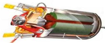
**Gambar 2.14** Konstruksi Motor DC
